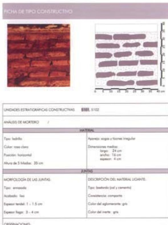
Il. 10. Ejemplo de ficha de tipo constructivo de los muros
