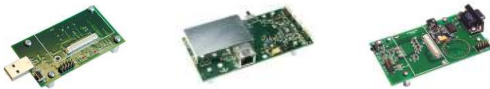
Figura 4.10. Dispositivos para conexión con estaciones base: MIB520 (izquierda), MIB600 (centro) y MIB510 (derecha).
