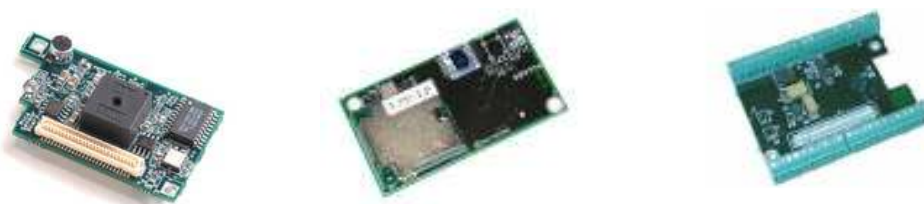
Figura 4.11. Tarjetas de adquisición de datos: MTS101 (izquierda), MTS420 (centro) y MDA300 (derecha).
