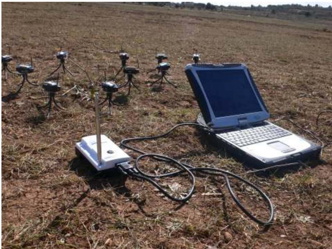
Figura 4.30. Sistema de adquisición de datos y puesto de mando local (estación base).
