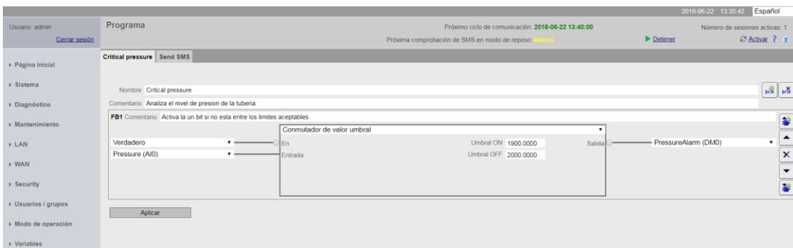
Fig.20 Diseño del bloque de programa de presión en SIMATIC RTU3030C
