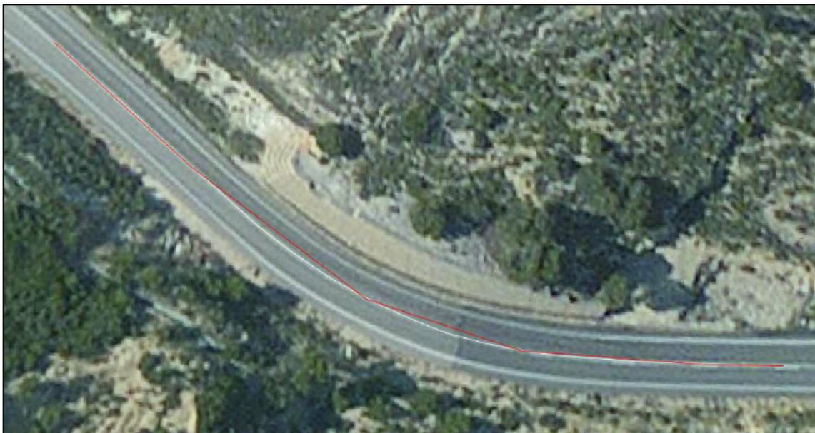
**Figura 5.4 Polilínea sobre el eje de la calzada con baja densidad de puntos**
