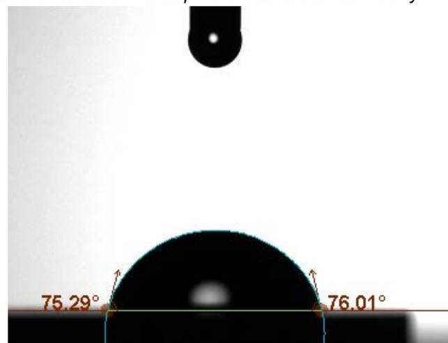
**Figura 14.** Medida de WCA de un chip de SOI. WCA entre  $75^\circ$  y  $80^\circ$ .
