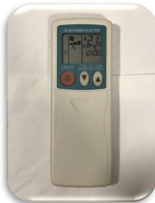
Figura 174. Mando/ Termostato PAR-SL 100
