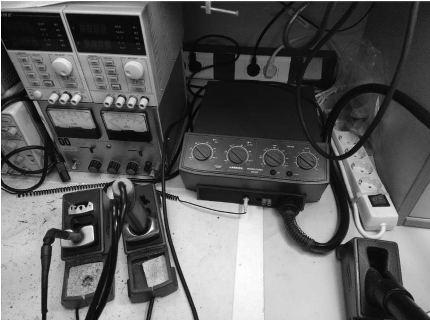
*Figura 8 – Estación de soldadura del laboratorio (arriba)*
