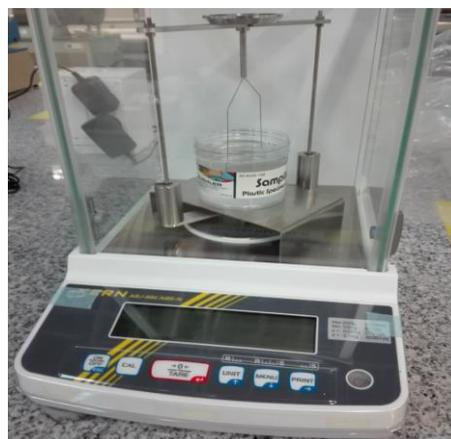
**Figura 16.** Montaje para obtener los valores de masa necesarios para aplicar el principio de Arquímedes.
