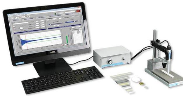
**Figura 17.** Equipo de Sonelastic. Consta de un soporte para las muestras con el sensor acústico incorporado y un computador para el tratamiento de las señales obtenidas.
