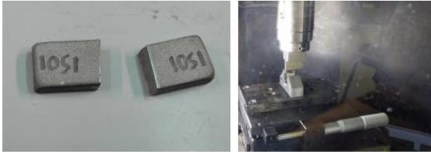
**Figura 18.** En la izquierda, rotura esperada de las probetas de flexión. A la derecha, el ensayo de flexión a tres puntos, en los que se puede distinguir la muestra biapoyada y el aplicador de la fuerza.
