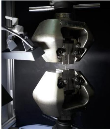
**Figura 20.** Montaje del ensayo de microtracción. La probeta es sujeta por ambos extremos por las mordazas inferior y superior.
