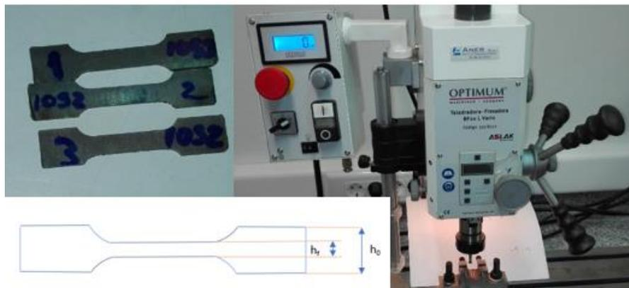
**Figura 19.** Abajo a la izquierda, la forma de las probetas de flexión tras el fresado, con el diámetro interior  $h_f$  y el exterior  $h_0$ . A la derecha se puede observar la máquina fresadora utilizada para la reducción del espesor de las piezas. Arriba a la izquierda se muestran las probetas de microtracción tras el corte.
