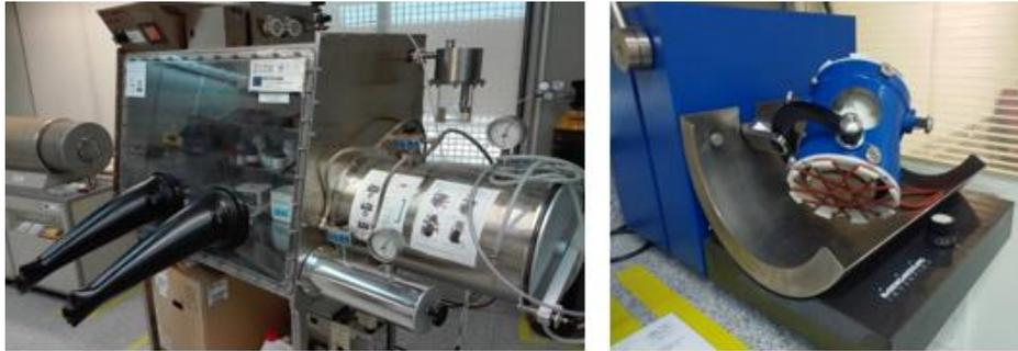
**Figura 14.** Cámara de guantes con control de presión, a la izquierda, y túbula para la homogenización de las mezclas, a la derecha.
