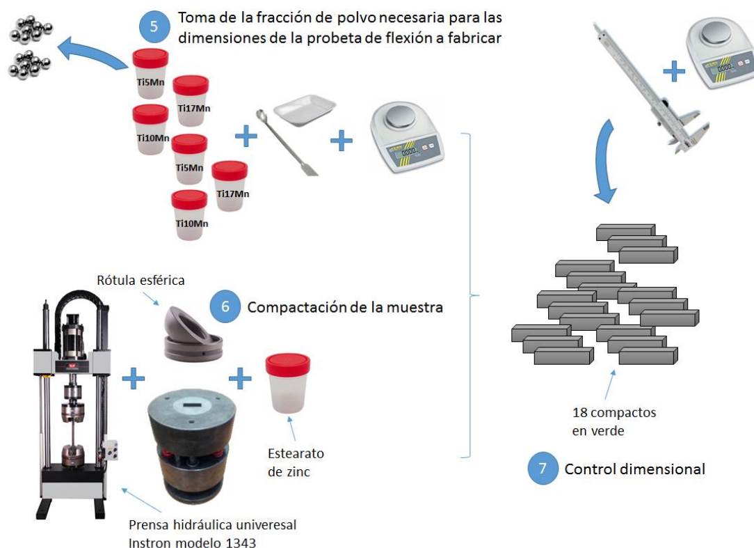
Figura 1.4. Esquema de la etapa de compactación de las muestras
