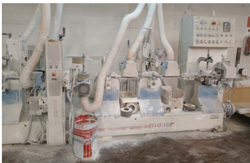
Fig. 9 Imagen polvo de lija acumulado en V1-V2
