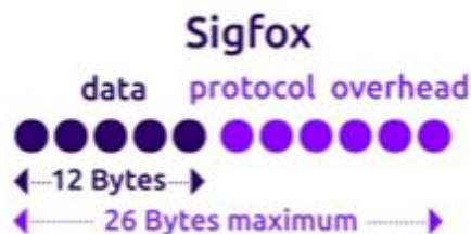
Figura 20 - Formato de los mensajes de Sigfox. Fuente Sigfox [1]
