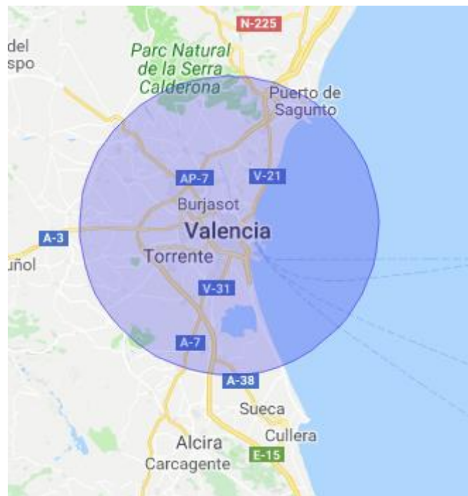
Figura 58 – Radio de cobertura de Sigfox para entornos rurales.
