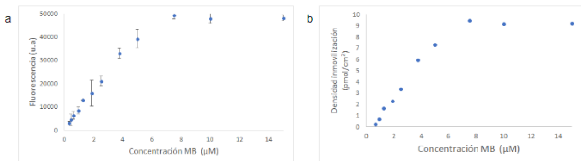
Figura 16. a) Relación entre intensidad de fluorescencia tras lavar y concentración del MB. b) Relación entre densidad del MB tras lavar y su concentración correspondiente.
