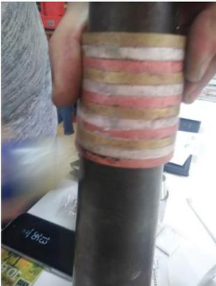
Seguidamente se debe dar la forma curva al brazalete con un martillo de punta blanda y un cilindro de metal, sobre el que se le va dando la forma a la pieza dando suaves golpes con el martillo por toda la superficie hasta conseguir el resultado deseado.
