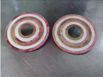
Una vez obtenidas todas las coronas circulares, seguidamente se liman los bordes de cada una y se sueldan todas ellas con soldadura de plata. El siguiente paso es soldar los orejales y limar el extremo de estos para que no quede una superficie rugosa y pueda dañar la oreja al introducirlos. Y como no, limar los trozos sobrantes que sobresalgan más de toda la pieza.
