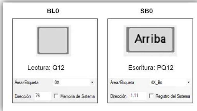
*Figura 5.48. Esquema de direccionamiento de los elementos “BL0” y “SB0” contenidos en la pantalla “Modo manual” en el sector Manipulador*
