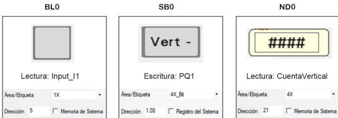
Figura 5.45. Esquema de direccionamiento de los elementos “BLO”, “SB0” y “ND0” contenidos en la pantalla “Modo Manual” en el sector del Brazo-ventosa
