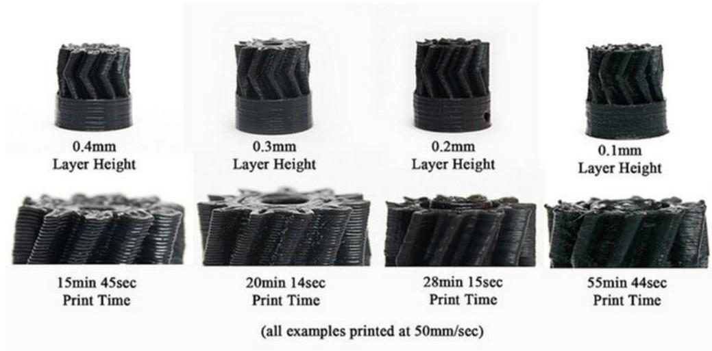
Ilustración 103 Piezas impresas con diferentes alturas de capa con sus correspondientes tiempos de impresión y calidad final
