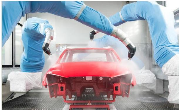
*Ilustración 14 Robots de pintura*
