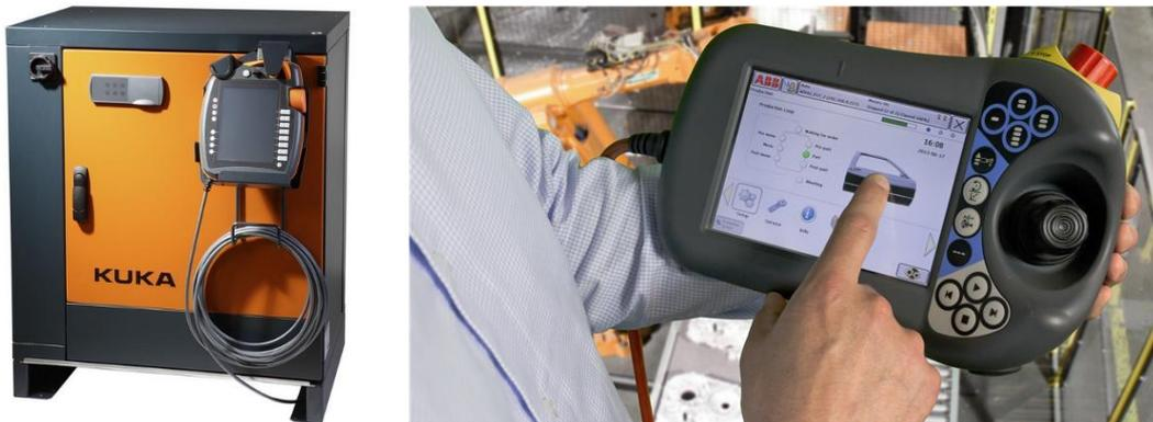
Ilustración 16 Armario Kuka con TP, Mando Flexpendant ABB
