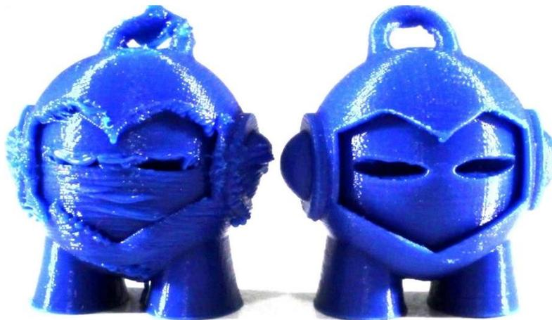
*Ilustración 108 Izquierda: pieza de PLA impresa sin refrigeración, Derecha: pieza con refrigeración*
