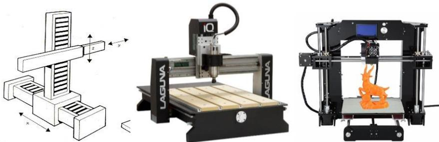
Ilustración 7 Esquema robot cartesiano, CNC e Impresora 3d
