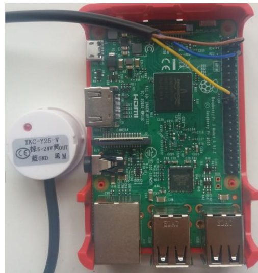
Figura 5.21 Conexionado sensor de nivel de agua real
