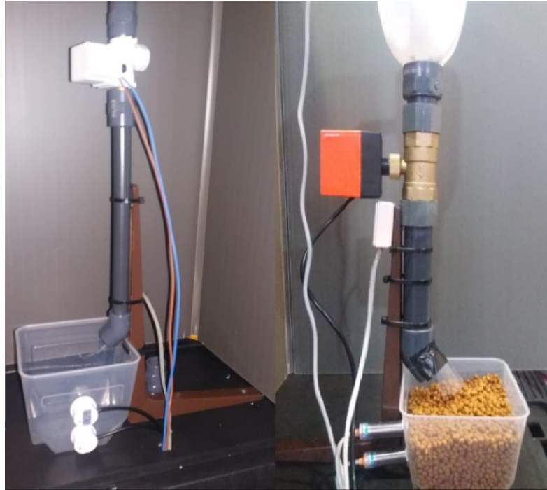
Figura 5.42 Tubos PVC junto con válvulas sujetos a las escuadras
