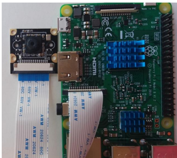
Figura 5.34 Conexión cámara real
