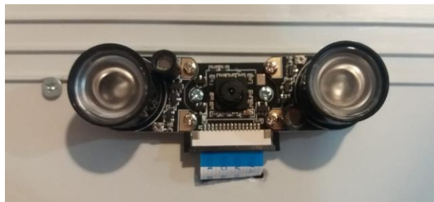
Figura 5.48 Parte trasera de caja con cámara de visión nocturna
