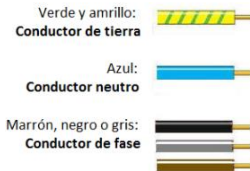
Figura 5.25 Colores de cables que contiene una manguera
