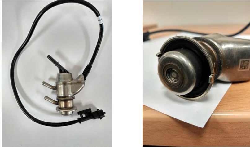
FIGURA 4.2. INYECTOR DE UREA.
