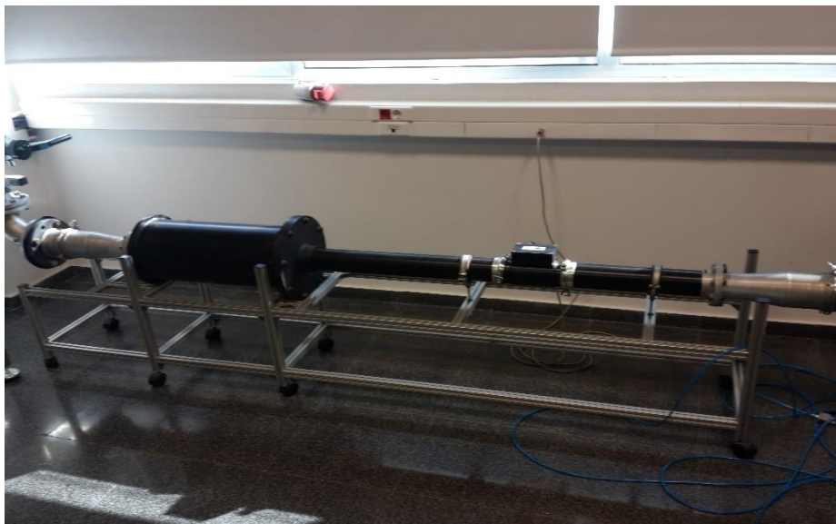
FIGURA 3.8. INSTALACIÓN DE FLUJO DE AIRE.
