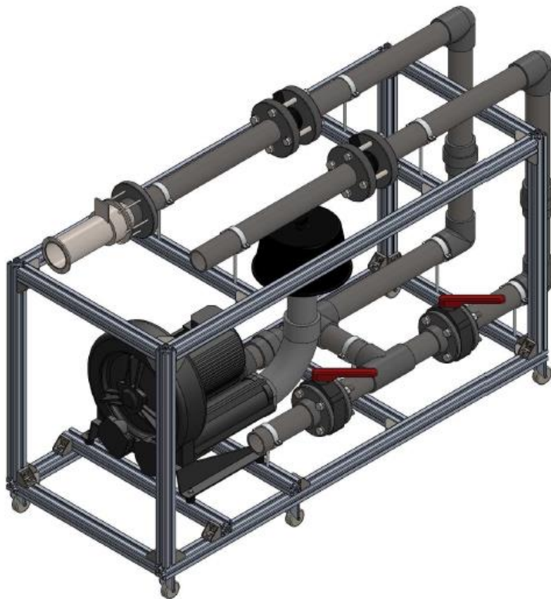
FIGURA 3.5. RENDERIZADO INSTALACIÓN DE FLUJO DE AIRE [3].
