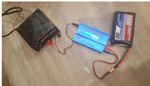
Ilustración 49 Montaje de carga de batería: a la izquierda el bloque de carga, al centro el cargador con equilibrador y a la derecha, la batería.
