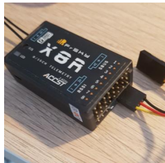
Ilustración 30 Receptor de radio que se conectará en el UA
