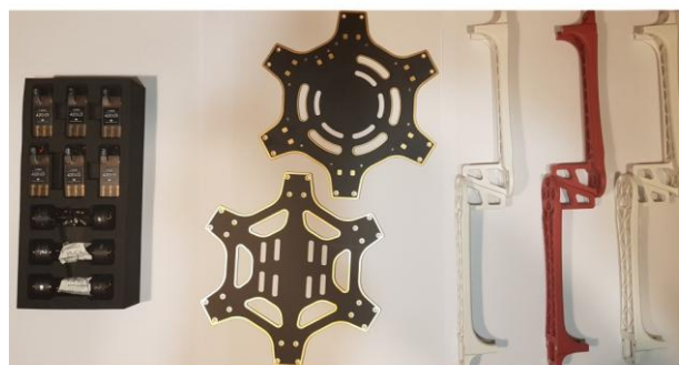
Ilustración 18 A la izquierda, motores y actuadores DJI en su caja; a la derecha, la estructura Flame Wheel ARF F550 de DJI
