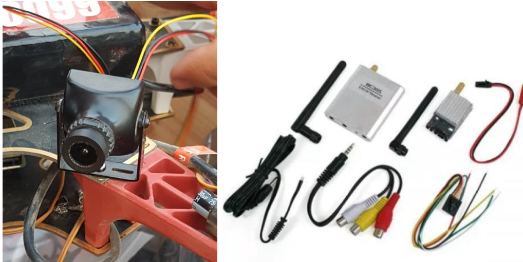
Ilustración 33 Cámara Foxeer a la izquierda. Equipo de transmisión y recepción a la derecha
