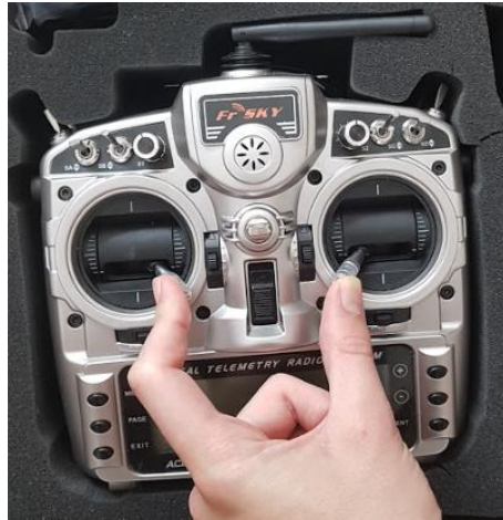
Ilustración 39 Imagen de la posición de palancas que arma los motores
