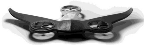
Ilustración 11 Pequeño UA alimentado con placas solares
