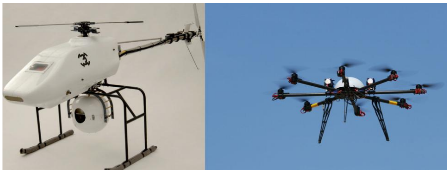
Ilustración 7 UA tipo Helicóptero a la izquierda y tipo multicóptero a la derecha
