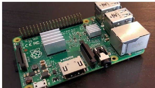
Ilustración 26 Raspberry con los radiadores colocados
