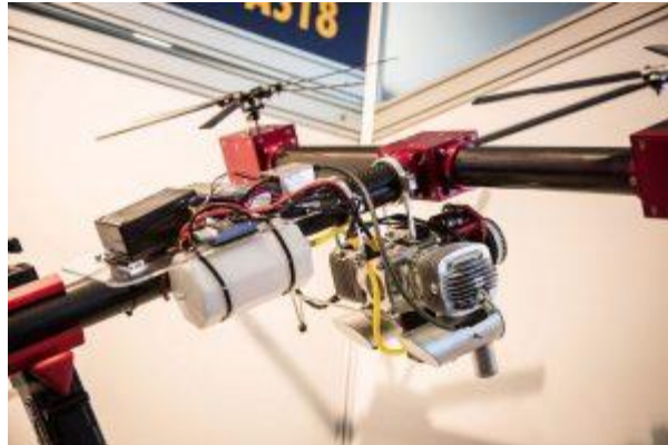
Ilustración 10 Detalle del motor fósil de un UA
