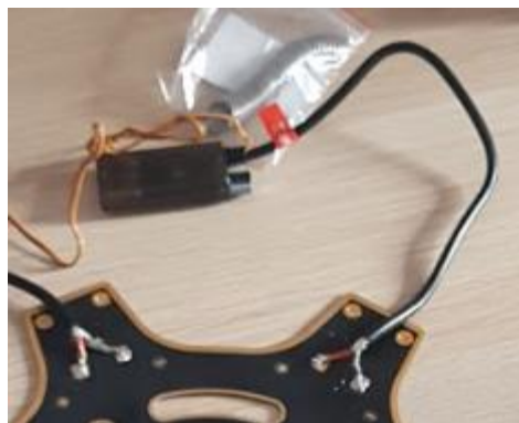
Ilustración 19 Detalle del primer variador soldado
