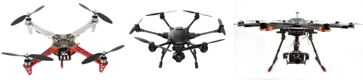
Ilustración 8 Distintos tipos de multicóptero según su número de motores
