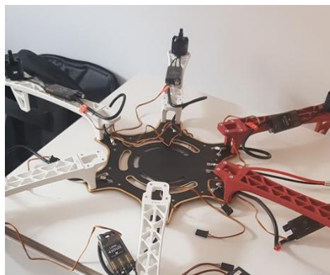
Ilustración 22 Motores, estructura y cableado preparados
