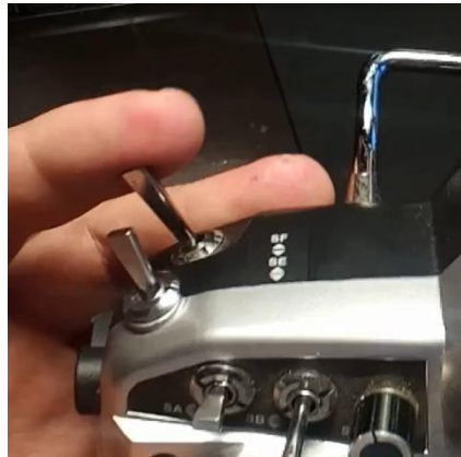
Ilustración 54 Detalle del conector SF, el cual es de dos posiciones
