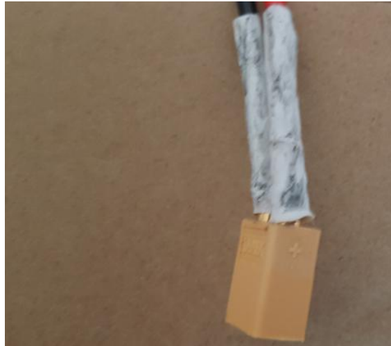
Ilustración 21 Termorretráctil aplicado al conector
