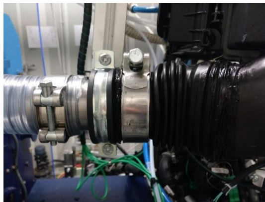
Figura 17. Detalle acople filtro-manguera admisión.
