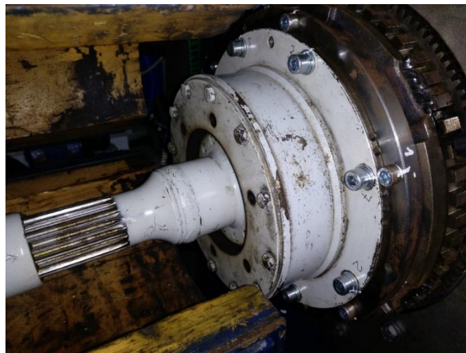
Figura 12. Acoplamiento motor-transmisión con disco adaptador transmisión.
