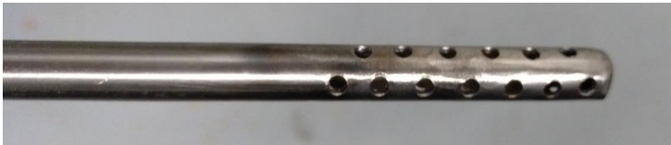
Figura 35. Imagen de sonda fabricada a partir de varilla de acero inox. de 6mm.
