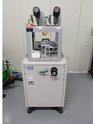
Figura 37. Imagen del módulo R-EGR-01 para medición de porcentaje de EGR.
