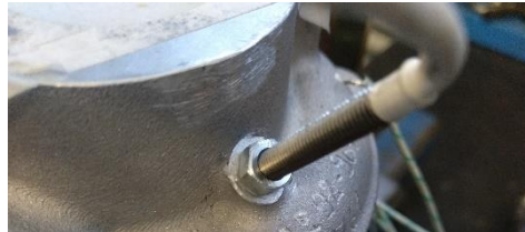
Figura 24. Detalle instalación sensor rpm.
