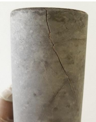
Fig. 21. Grieta en uno de los cilindros.
