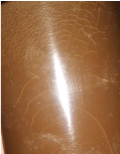
Fig. 28. Detalle de la red de fracturas generada en el cilindro 268.
