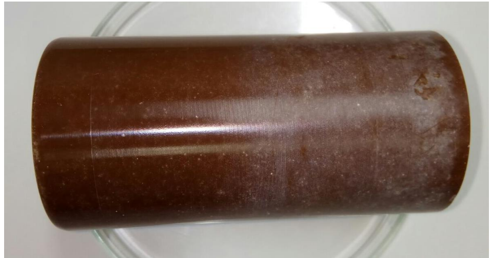
Fig. 27. Cilindro 268 tras el tratamiento de limpieza realizado en el 50% de su superficie.
