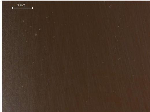
Fig. 54: Foto tomada a 8x tras 30 minutos de exposición a luz UVC
