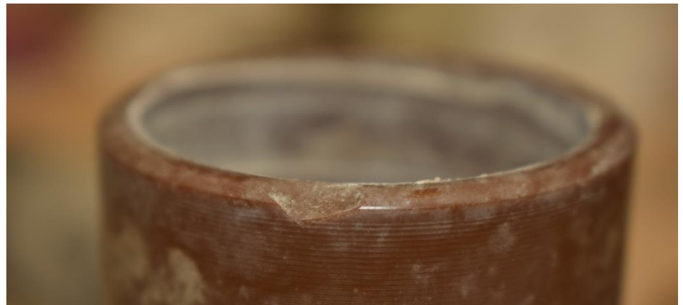
Fig. 20. Detalle de faltante en el borde de un cilindro debido a la mala manipulación.
