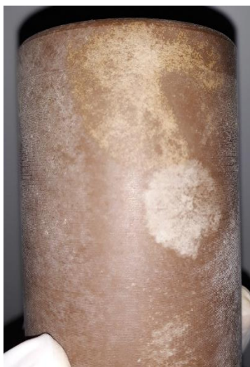
Fig. 24. Cilindro con manchas provocadas por proliferación de hongos.
