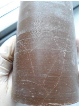
Fig. 18. Cilindro con red de fisuras internas.
