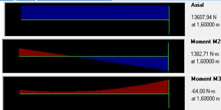
Fig. 87 Axil, momento en Y y momento en Z de la barra 260 bajo la combinación ELU 4ªROTURA CONDUCTOR 2.
