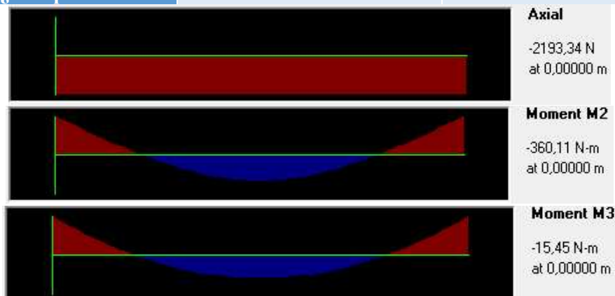
Fig. 96 Axil, momento en Y y momento en Z de la barra 277 bajo la combinación ELU 1ªVIENTO +X.
