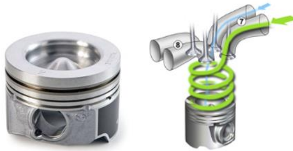
Figura 3.3: Bowl y Swirl en un motor MEC
