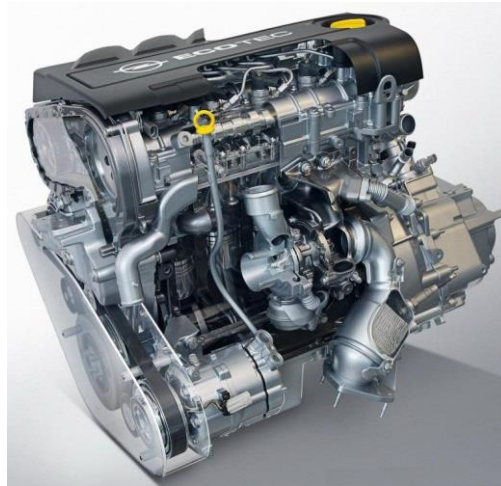
Figura 2.1: Motor diésel de inyección directa del proyecto [36]
