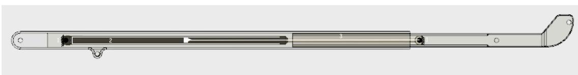
Figura 5.32 – Mecanismo pistón telescopio
