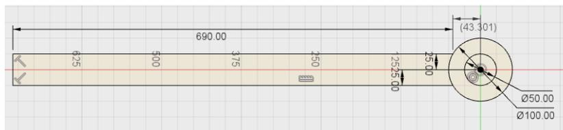
Figura 4.28 – Croquis del vástago del Pistón Inferior
