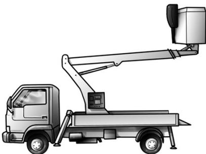
Figura 3.3 – PEMP sobre camión articulada o telescópica
