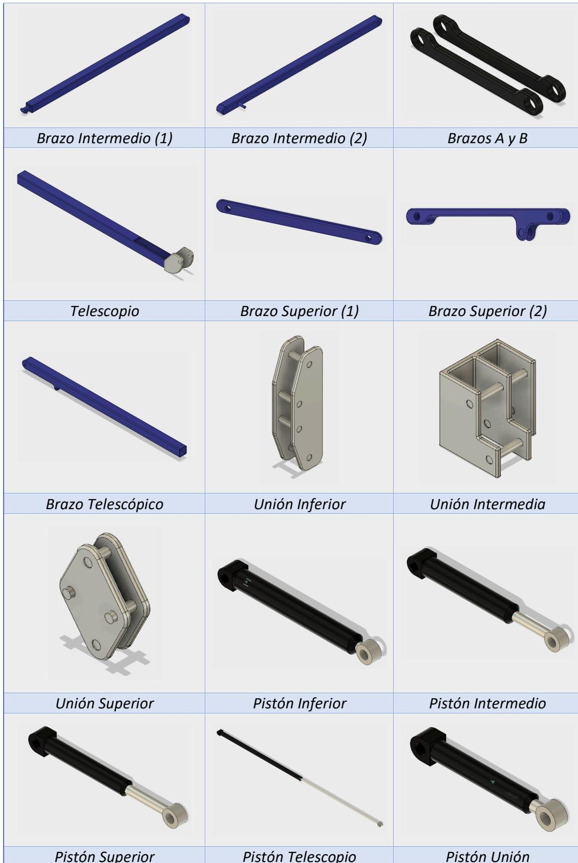
Figura 4.30 – Resultado del modelado de las piezas
