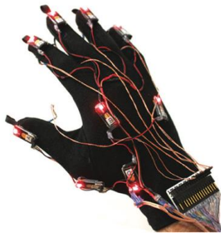
Figura 6. Guante con marcadores para el seguimiento y posicionamiento de los mismos [7].
