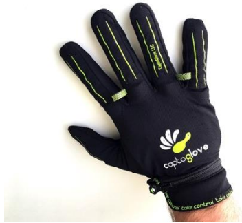
Figura 5. CaptoGlove 8 . Wearable controlador para videojuegos y dispositivos inteligentes.
