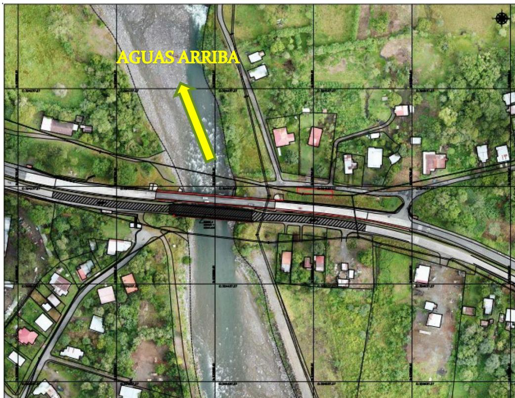
A pesar de que se ha demandado un levantamiento especial con láser escáner de los puentes, el trabajo podría realizarse plenamente mediante topografía clásica utilizando sólo la estación total. La forma de proceder sería tomando puntos singulares de la estructura del puente, para después unirlos y vectorizar en AutoCAD el dibujo final.
