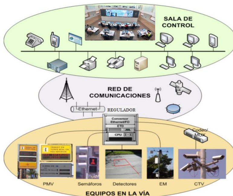
Figura 2. Organización de un Sistema de Control de Tráfico
