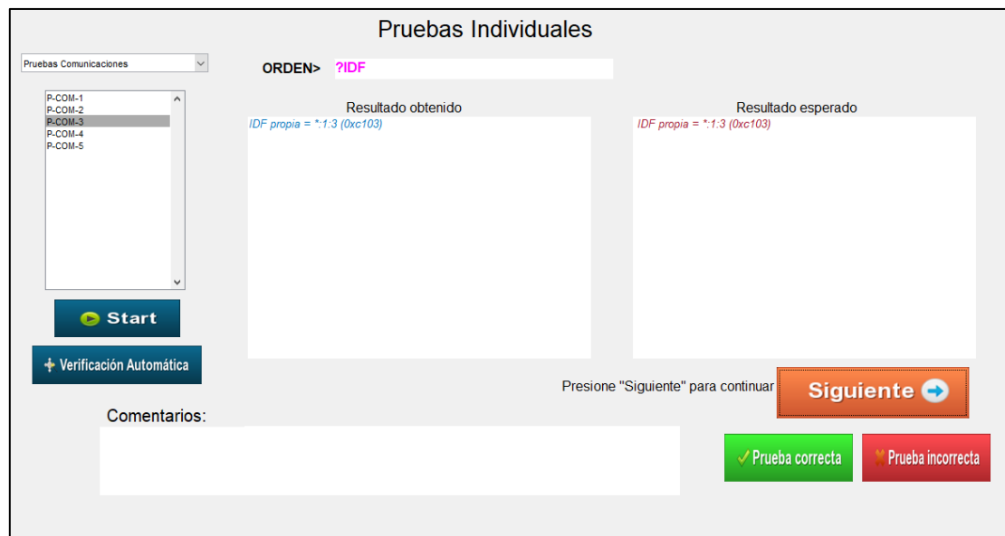
Figura 47. Envío del comando "?IDF" con conexión central-regulador (PCOM3-Automatizada)
