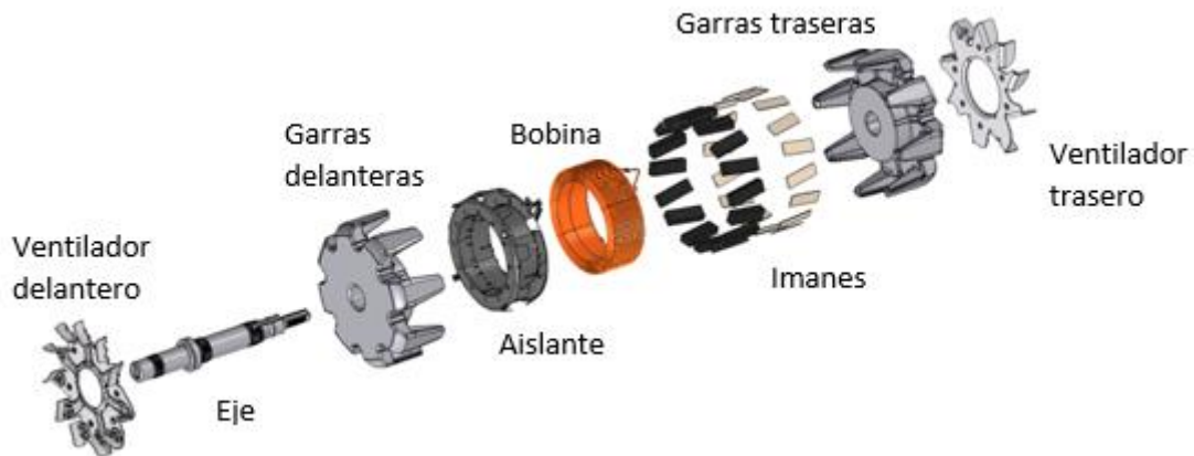
Figura 6: Explosión del rotor del IBSG-HP
