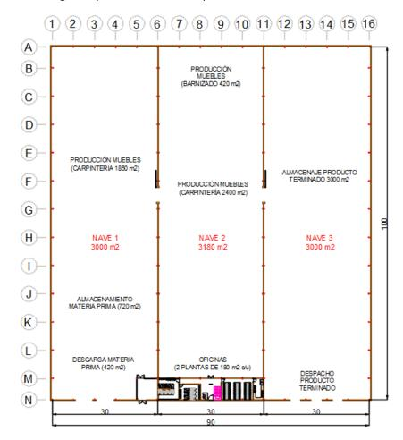
Figura 1. Distribución en planta de las áreas de trabajo
