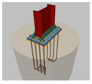
Figura 21. Placa de anclaje pilares centrales de pórticos interiores
