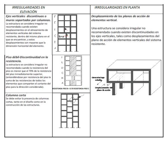
Figura 30. Configuraciones estructurales no recomendadas
