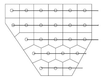
Figura 8. Determinación de la superficie cubierta por rociador
