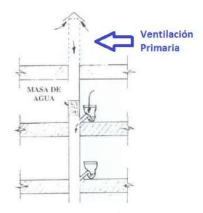
Figura 1. Ventilación primaria
