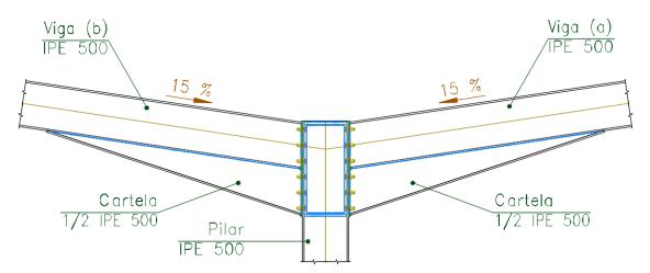
Figura 9. Detalle conexión cartela en pilares centrales
