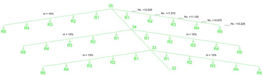
Esquema Ramal de Rociadores en Cubierta
