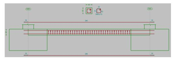
Figura 4. Detalle viga de atado
