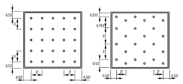
Figura 7. Separación para rociadores de techo
