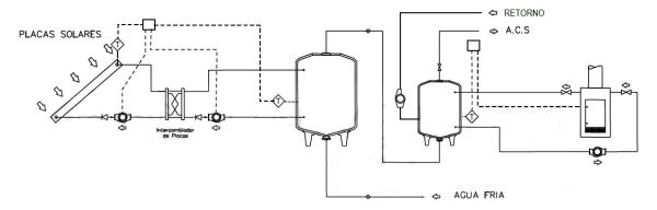
Figura 1. Esquema hidráulico de instalación centralizada con retorno
