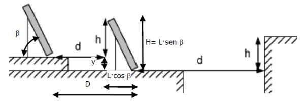
Figura 2. Inclinación y separación entre captadores
