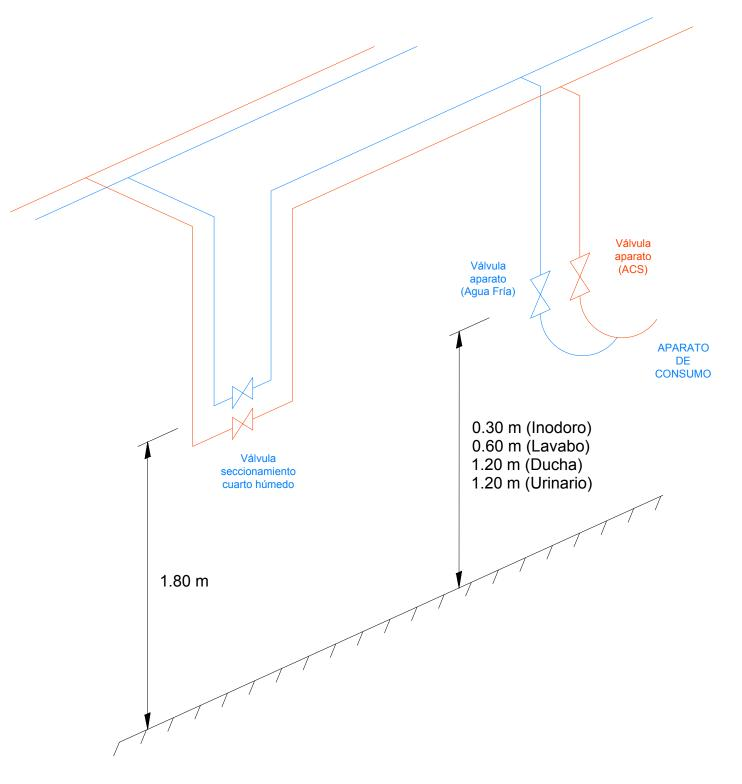
Esquema isométrico de puntos de consumo
