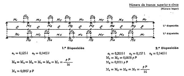
Figura 18. Disposición de rótulas en función de un número impar de vanos
