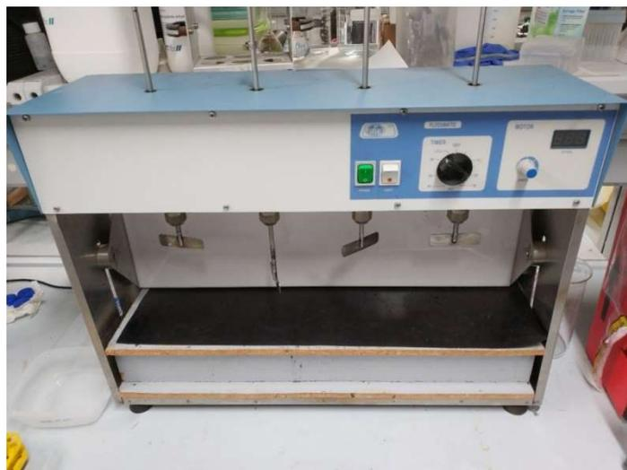
**Figura 7.** Equipo Jar-test de Selecta.
