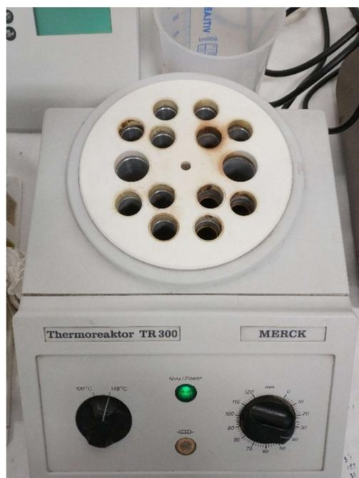
**Figura 20.** Termorreaktor marca Merck, modelo TR 300.
