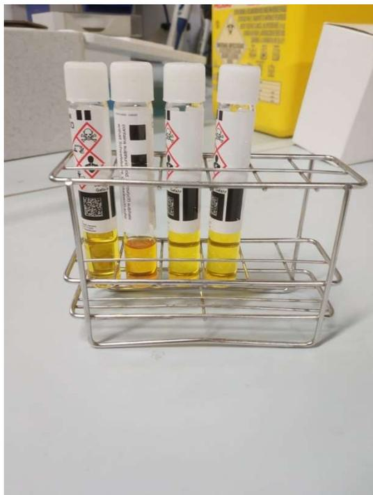
**Figura 19.** Tubos con el compuesto preparado del Kit de DQO empelado.
