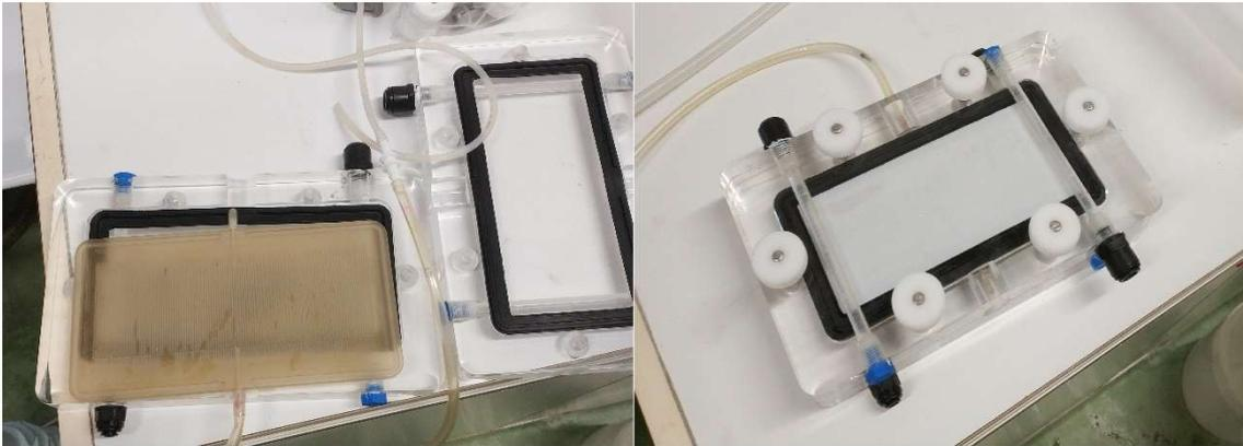
**Figura 12.** Módulo de membrana de ORELIS desmontado (izquierda) y montado (derecha).
