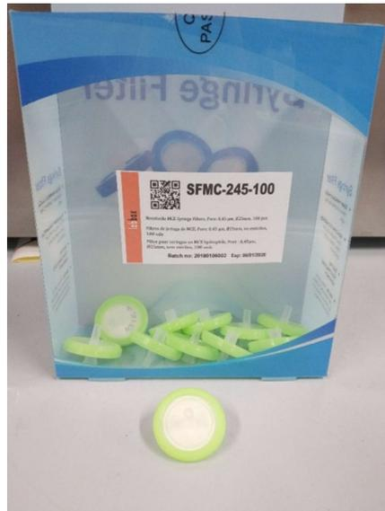
**Figura 9.** Filtros adaptados de  $0,45 \mu\text{m}$  para jeringuillas de la marca Labbox.
