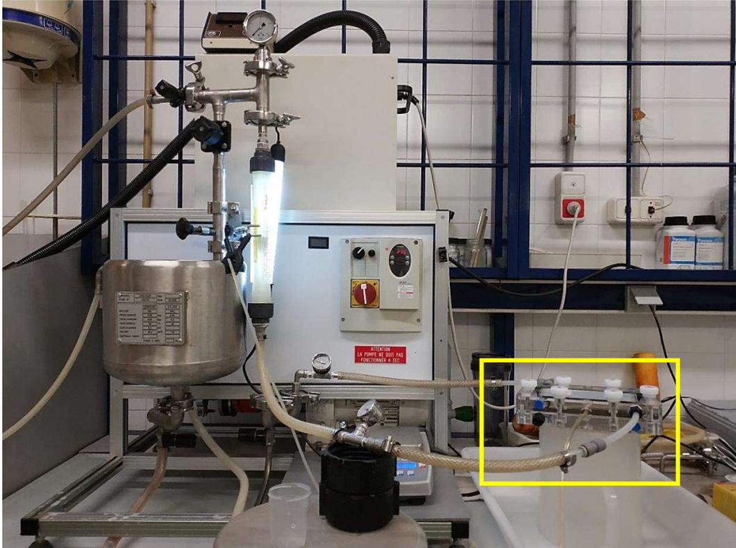
Figura 10. Planta piloto de laboratorio con módulo de membranas de ultrafiltración
