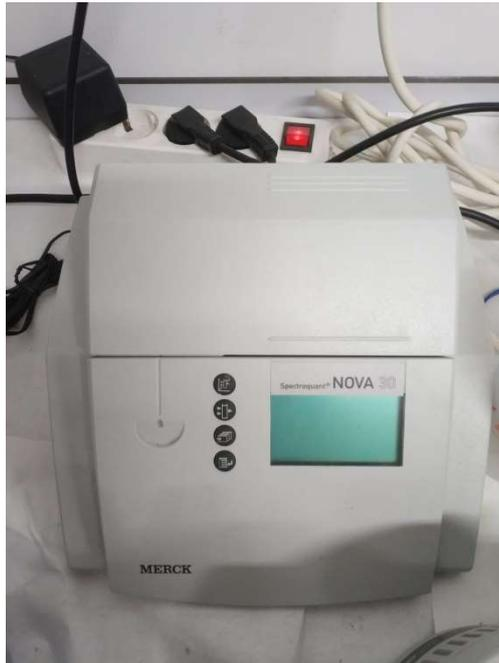
**Figura 21.** Fotómetro para la medición de DQO, marca Merck, modelo NOVA 30.
