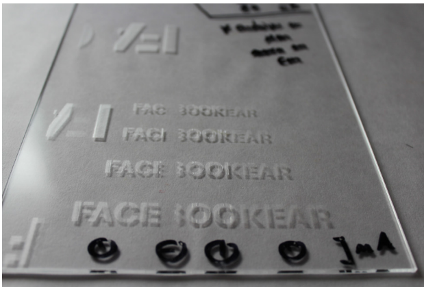
Pruebas de grabado láser sobre metacrilato.
