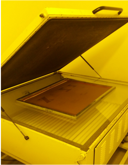
Fig. 30. Pantalla de serigrafía en la insoladora.
