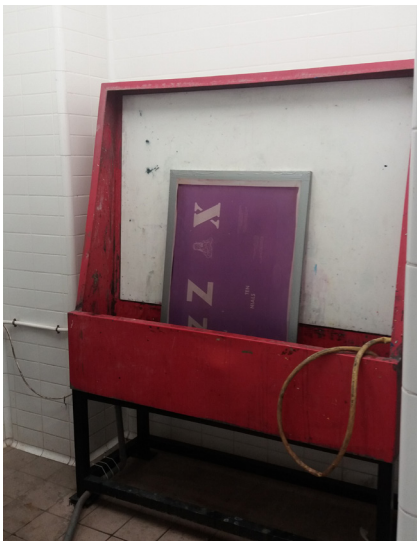
Fig. 31. Pantalla de serigrafía preparada para revelar la imagen insolada.
