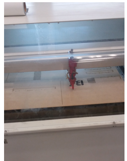
Fig. 35. Cortadora láser cortando las carpetas. Segunda Vista.
