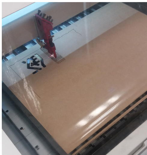
Fig. 34. Cortadora láser cortando las carpetas. Primera Vista.
