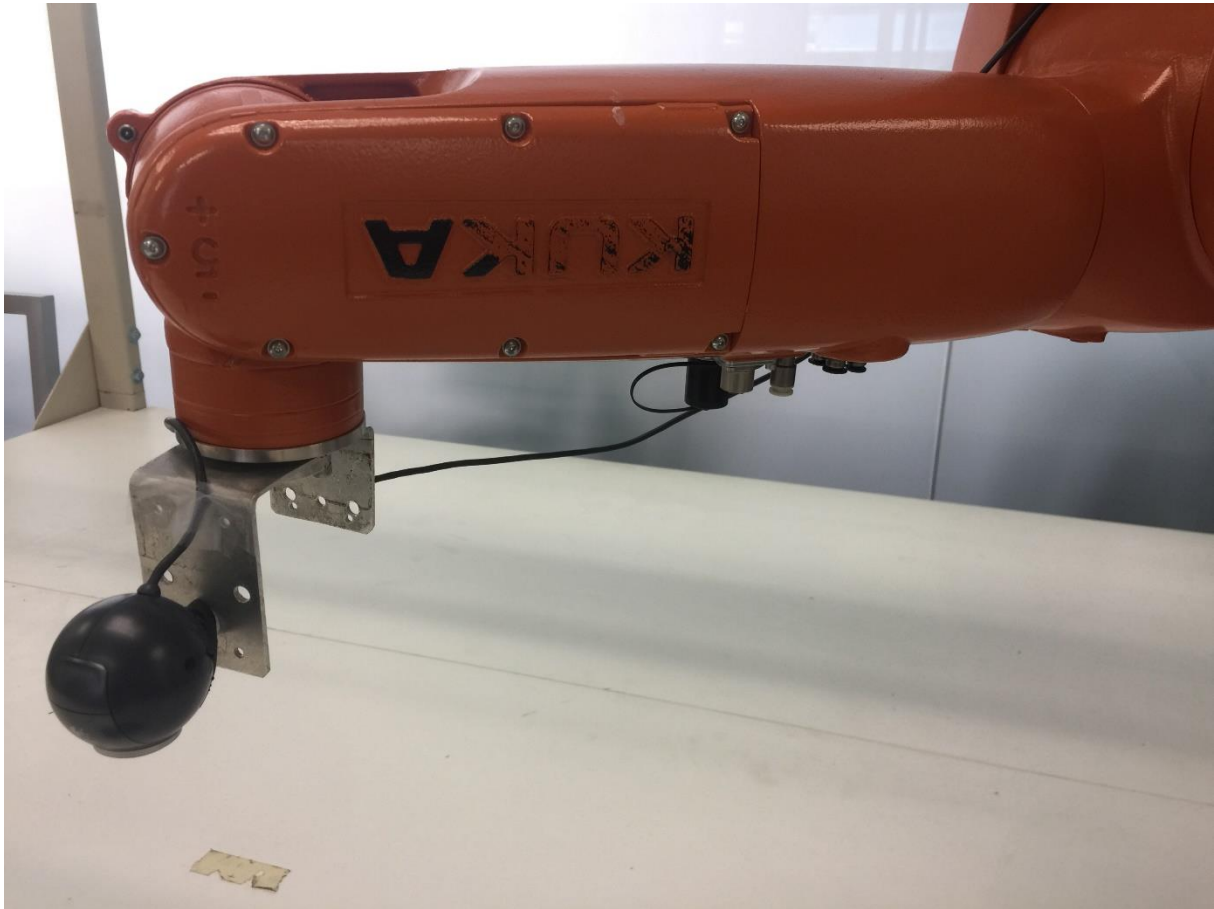
Figura 76-Webcam Logitech C300 fijada solidariamente al efector final del robot KUKA Agilus
