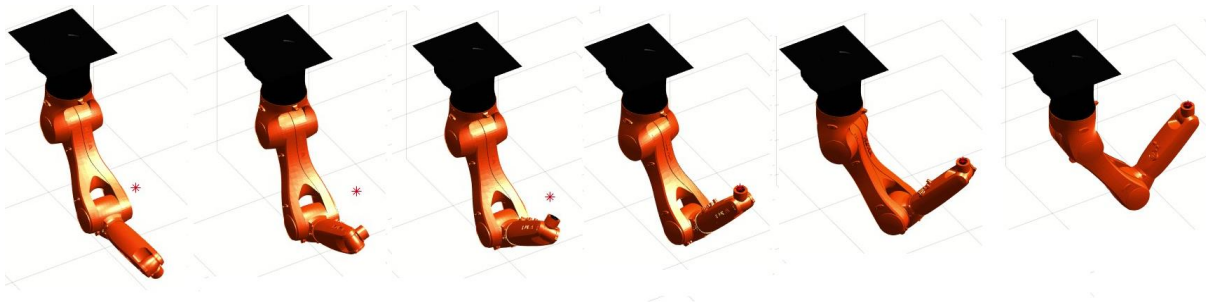
Figura 34-Tracking de una trayectoria en arco de circunferencia y orientación [0,0,0] (rpy)
