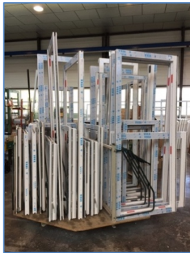
Figura 28 Rueda de almacenaje de hojas después de la colocación del herraje (Fuente: Elaboración propia)
