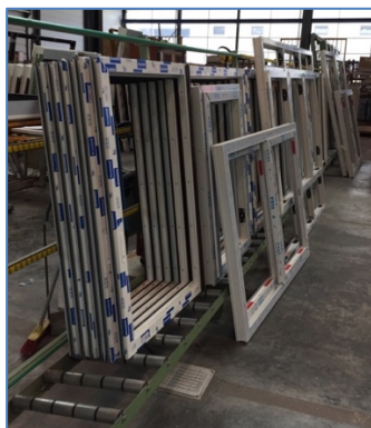
Figura 30 Almacén incontrolado 7. Banco de rodillos para la colocación de ventanas después del ensamblaje (Fuente: Elaboración propia)
