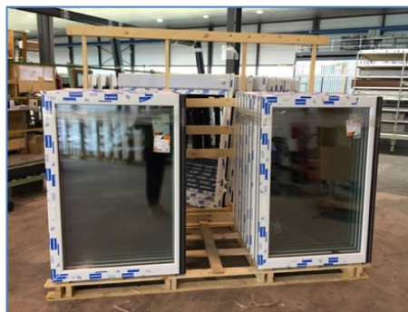
Figura 33 Operación de paletizado de ventanas (Fuente: Elaboración propia)
