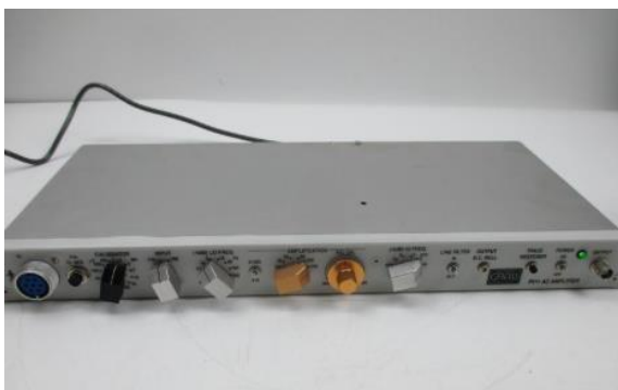
Figura 9: Amplificador Grass P511 AC (Natus, GrassP511 AC®)
