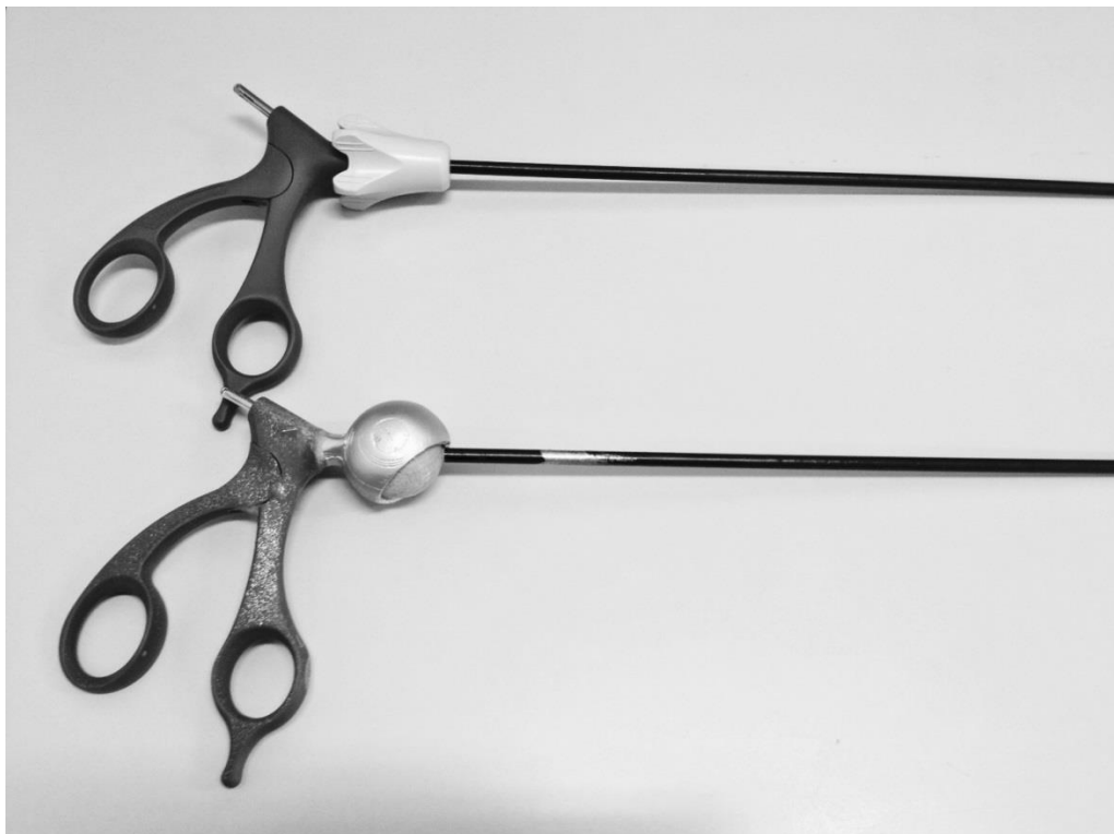
Figura 14: Laparoscopios empleados durante el estudio. Laparoscopio convencional (arriba) y laparoscopio de diseño (abajo) (Departamento DIE, ETSII, UPV).
