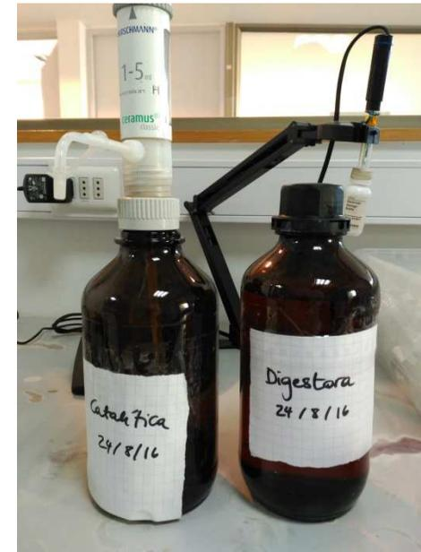
Fotografía 8, Solución digestora y catalítica para el cálculo de la DQO.
