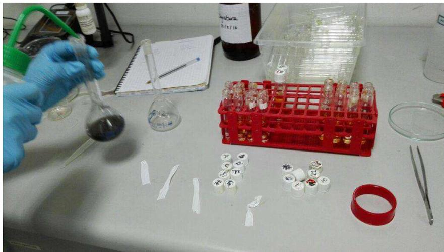
Fotografía 4, medición de DQO. Matraz aforado con 25 mL de disolución, tiras de teflón para obtener un buen cierre de los tubos y tubos numerados para poner en la placa térmica a digerir.
