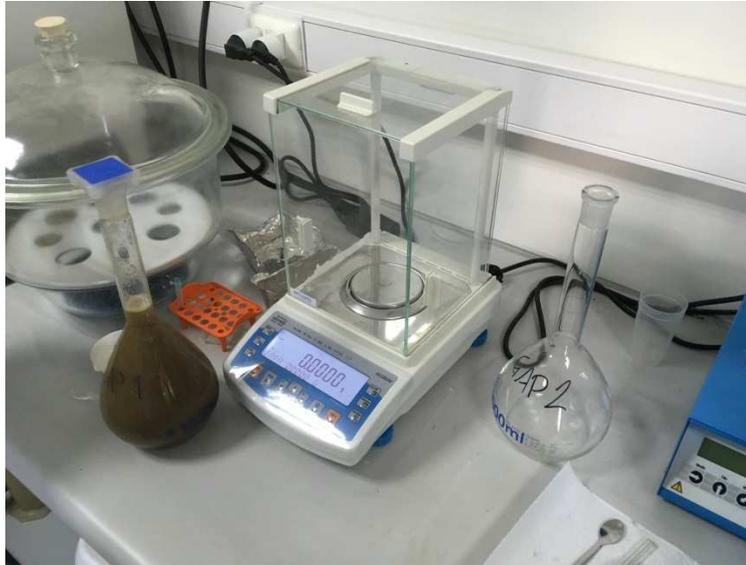
Fotografía 1, Balanza digital y matraz aforado con sustrato.
