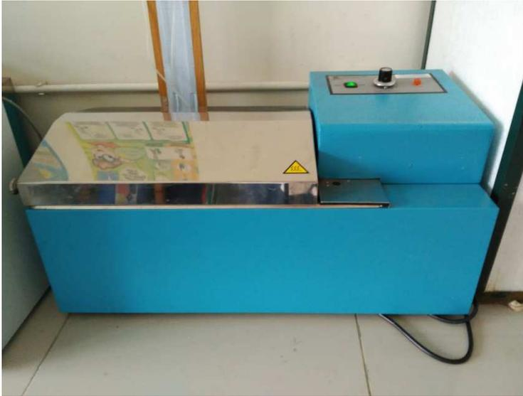
Fotografía 13, baño móvil con regulador de temperatura.
