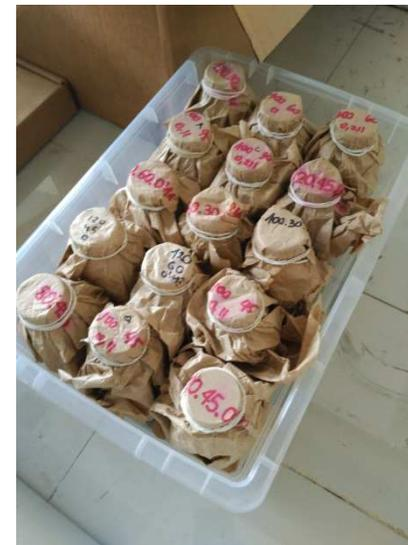
Fotografía 3, Viales con los pretratamientos preparados para meter en el autoclave.
