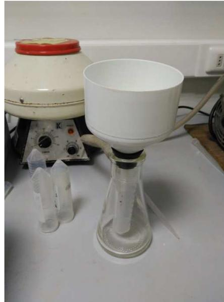
Fotografía 7, embudo generador de vacío.
