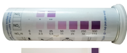
Gráfico 12. Identificación de la presencia de nitratos en las sales.
