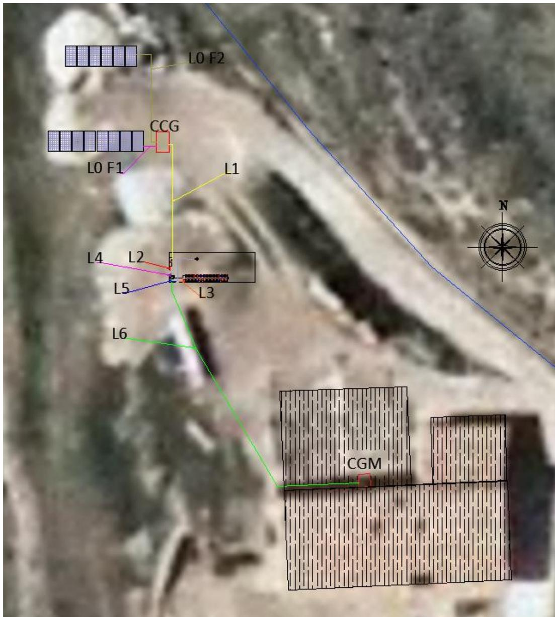
Figura 3 Esquema de líneas en corriente continua y corriente alterna
