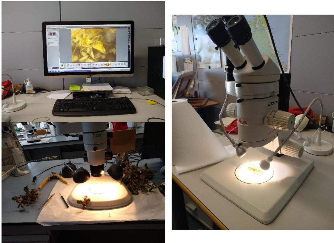
Figura 6. Herramienta de digitalización de imágenes (arriba izquierda), binocular utilizado en la observación de muestras vegetales (abajo izquierda) y binocular con cámara integrada utilizados para la identificación (derecha).
