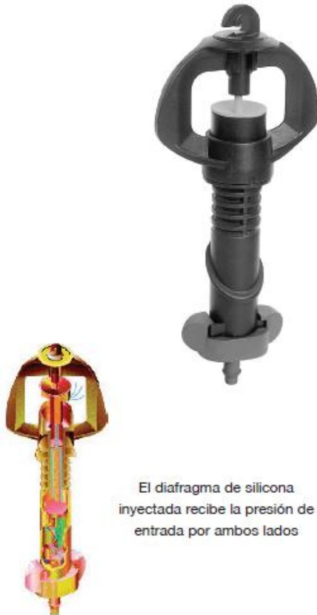
Figura 1. Esquema del microaspersor. Fuente: Regaber.
