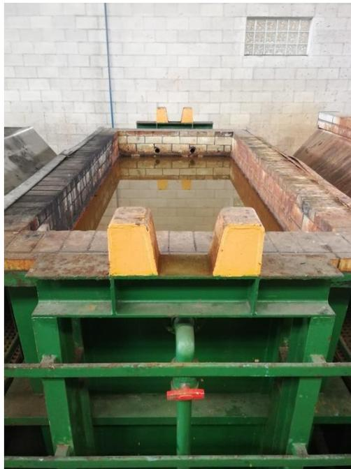
**Figura 1.4.8** Balsa para después del decapado. Formación del Preflux.
