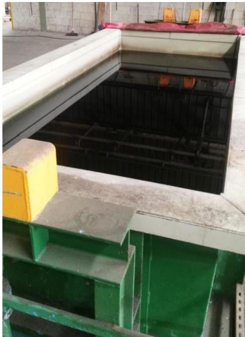
**Figura 1.4.11.** Balsa donde se realiza el pasivado de las piezas galvanizadas.
