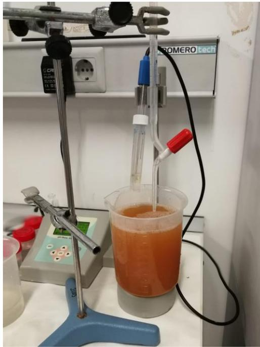
**Figura 1.8.1** Imagen del montaje del ajuste de pH de la disolución de  $\text{FeCl}_3$  con  $\text{NaOH}$  para ajustar el pH a 5.
