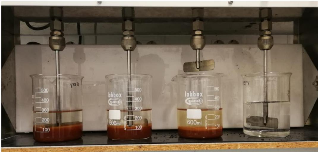
**Figura 1.8.2** Ensayo Jar Test con diferentes tipos de floculante y diferentes concentraciones de este.
