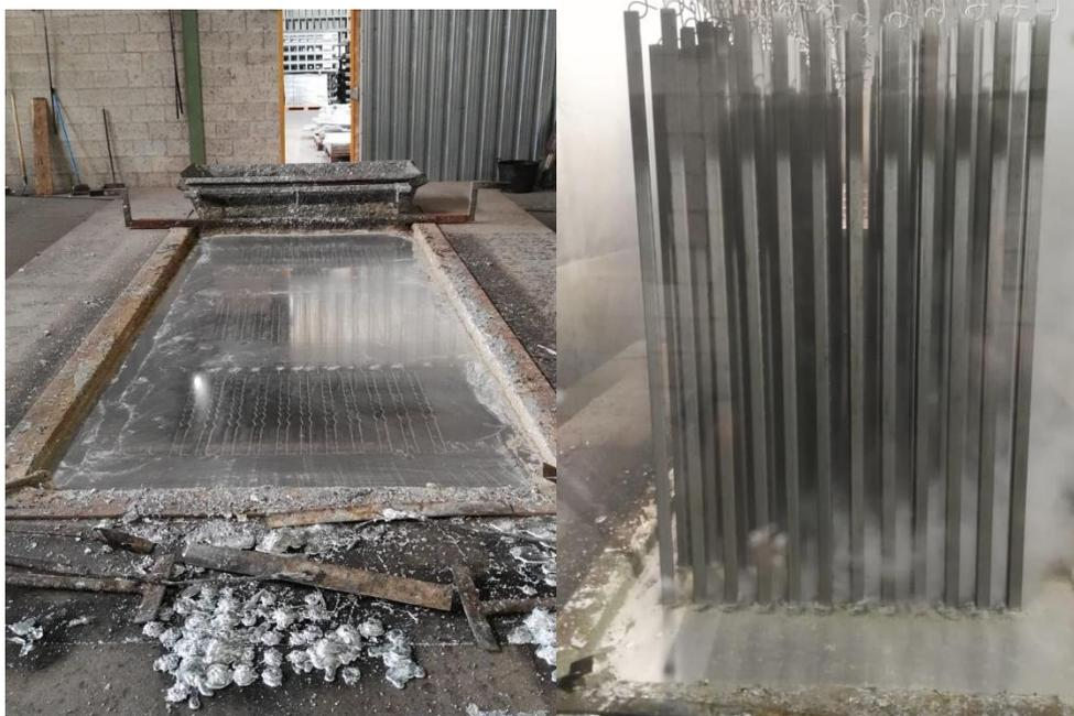
**Figura 1.4.10. Imágenes de la balsa y del proceso de galvanizado.**
