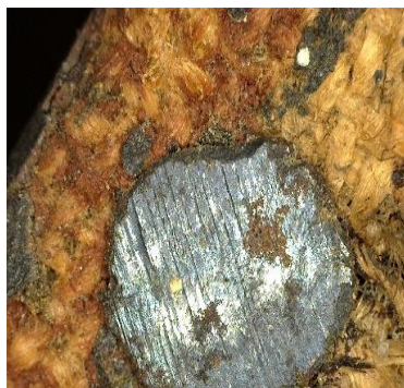
Fig.19. Fotografía macro de uno de los clavos que sujeta el lienzo por los bordes.
