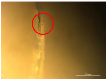
Figura 22. Nudo en la fibra vegetal a 100x.
