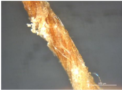
Figura 21. Torsión en Z de la muestra de hilo a 4x.
