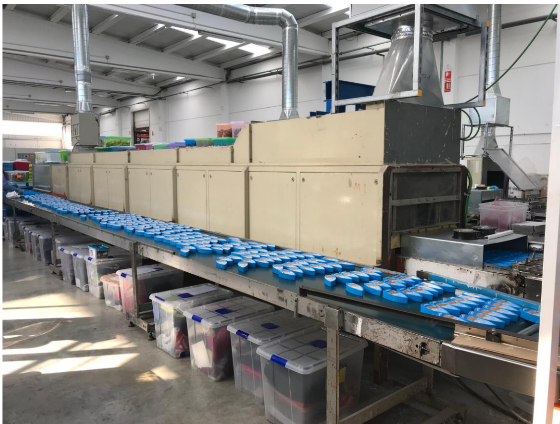
IMAGEN 5, TÚNEL DE REFRIGERACIÓN
