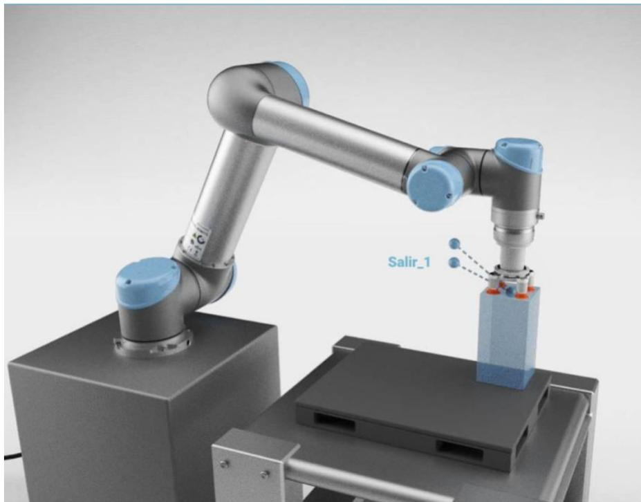
Figura 32. Imagen de los puntos que definen el movimiento de paletizado. [Fuente: <https://www.universal-robots.com/es/academy/>]
