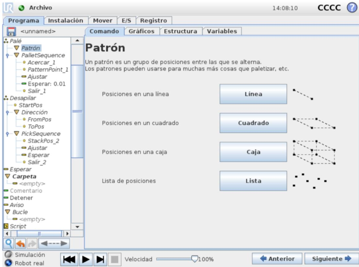
Figura 21. Pantallazo función Palé. [Fuente: [https://www.universal-robots.com/media/207448/ur3\\_user\\_manual\\_es\\_global.pdf](https://www.universal-robots.com/media/207448/ur3_user_manual_es_global.pdf)]
