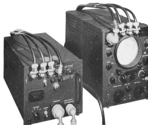
**Figura 13: Receptor del sistema LORAN – C.**
