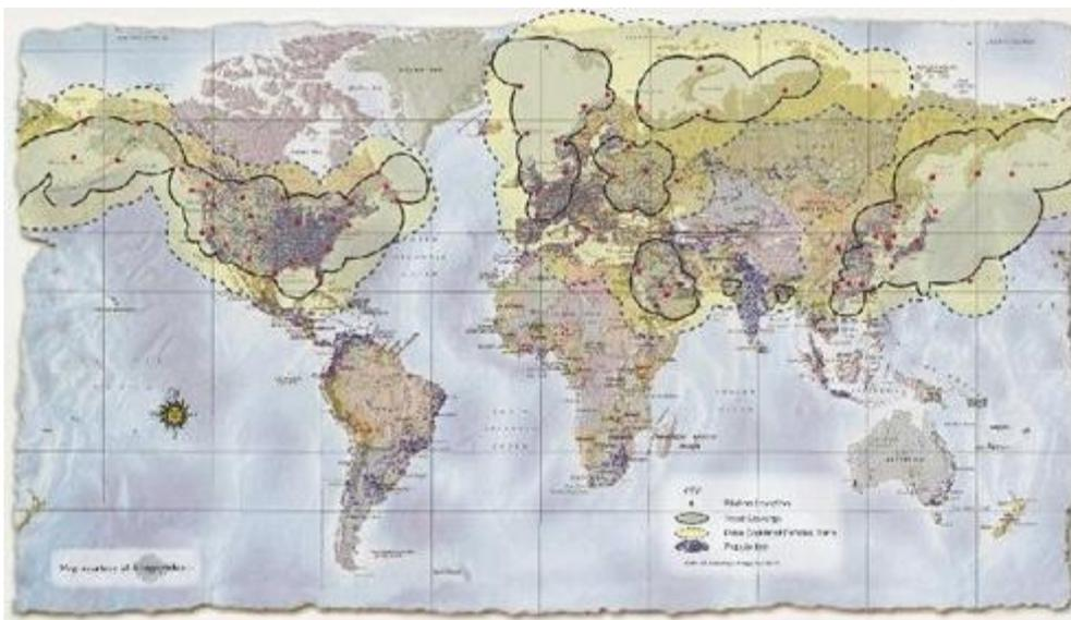
**Figura 12: Cobertura del sistema LORAN – C.**
