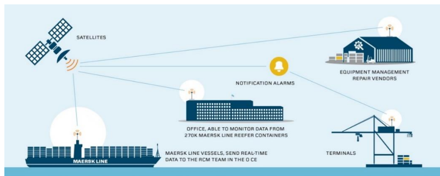
Figura 22. Esquema de funcionamiento de la solución de Maerks Line [28]
