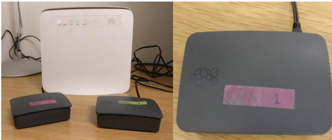
Figura 52. Montaje: router 4G y Raspberry Pis
