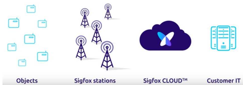
Figura 8. Elementos de la arquitectura de Sigfox [13]
