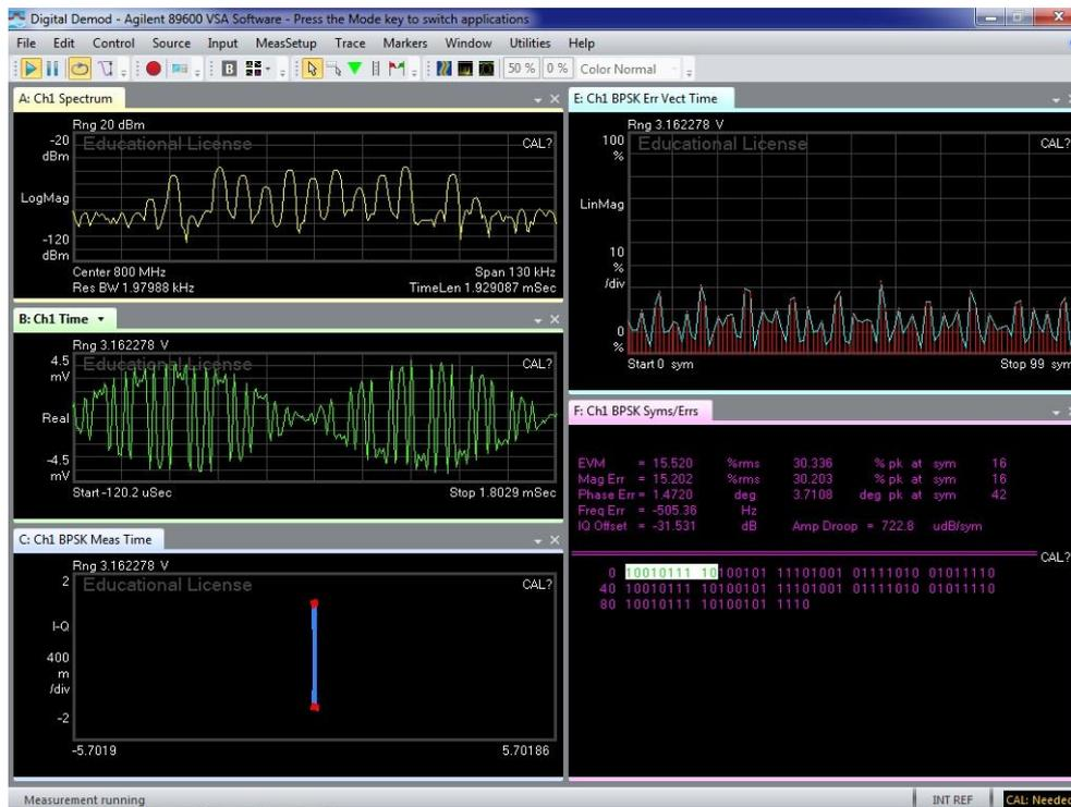
Figura 53. Pantalla del programa VSA con la demodulación de la secuencia de prueba
