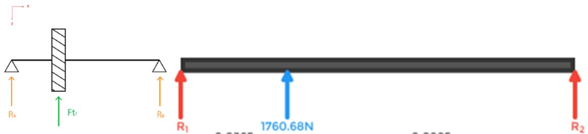
Figura 5. Diagrama eje entrada horario XZ
