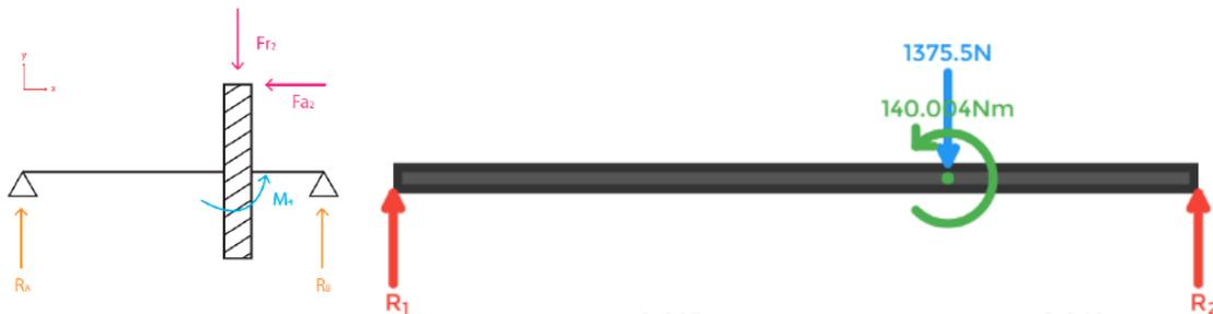
Figura 11. Diagrama eje salida horario XY
