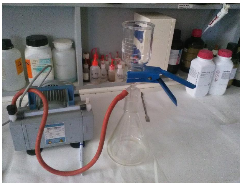
Figura 5 Equipo de filtración. Fuente: Elaboración propia.
