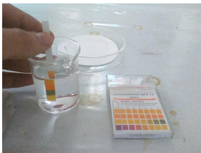
Figura 2 Midiendo el pH con las tiras indicadoras. Fuente: elaboración propia.
