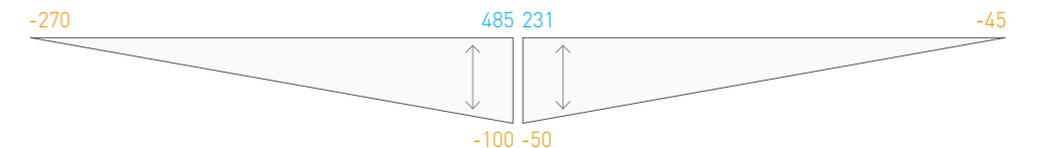
**F<sub>11</sub> | Costillas** (armadura horizontal Ø20 cada 20 cm)
